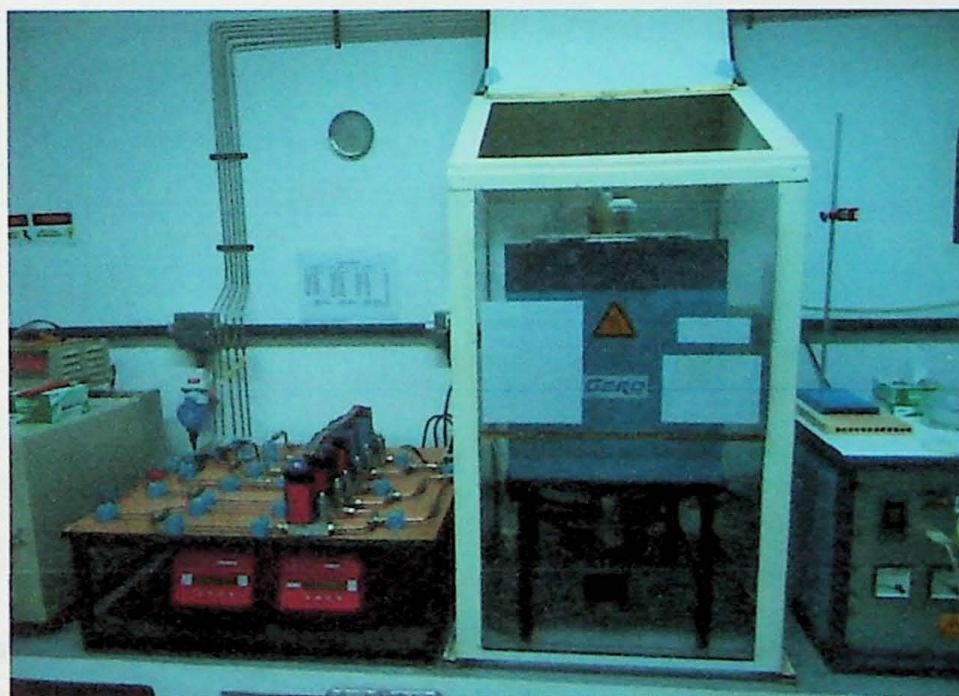
Foto 1 - Fornalha tubular vertical de alta temperatura GERO que atua sob pressão atmosférica, acoplada a um sistema misturador de gases (à esquerda da fornalha).
